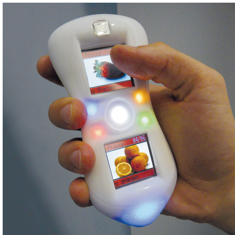
Le créateur de Smartio Systems a mis au point le Papoo, boîtier portable miniaturisé qui restitue par synthèse vocale des mots ou phrases associés à des images. La Région a aidé le démarrage en octroyant à Smartio Systems une aide à la faisabilité technologique (AFT) puis une avance remboursable dans le cadre de Pacte Création.
